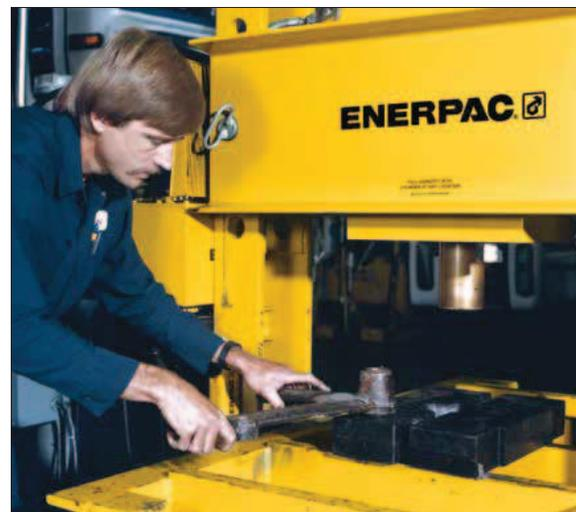
▲ Пресс BPR-20075 помогает извлечь большой вал из опорного блока. Конструкция с подвижной станиной позволяет безопасно загрузить тяжелые детали с использованием мостового крана.
