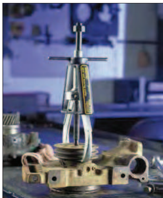
▲ Съемник EP-204 с двумя зажимами, установленный для вытаскивания приводного шкива водяного насоса.
