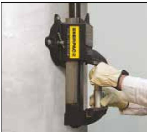
◀ Гидравлические тиски Enerpac BV-5, установленные в вертикальном положении для выполнения прессовочных работ с высокими усилиями.
