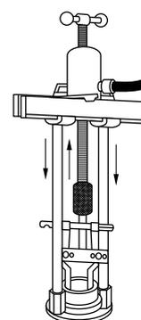
◀ Показан съемник для снятия обойм подшипников, подсоединенный к съемнику-хомуту.
