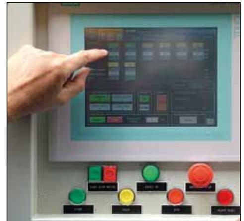
▲ Пульт микропроцессорного управления системы синхронного подъема высшего класса EPS.
