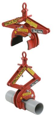
Новый регулируемый трубный захват Crosby Clamp-Co является превосходным механизмом для перемещения объектов цилиндрической формы. Новый захват имеет губки с прокладками и является превосходным механизмом для перемещения любых труб, прутков или столбов диаметром от 88,9 мм до 914 мм, особенно в случаях, когда не допускается повреждение поверхности материала.
