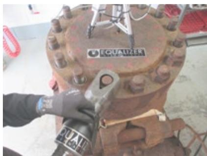
Гайкорез **Equalize NS36TE** срезает жароустойчивые гайки
