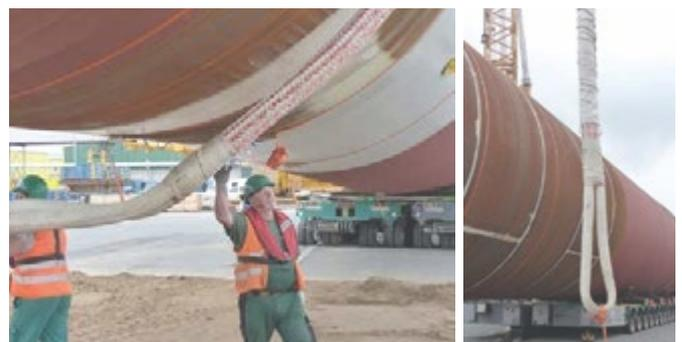
Строп грузоподъемностью 375 т
