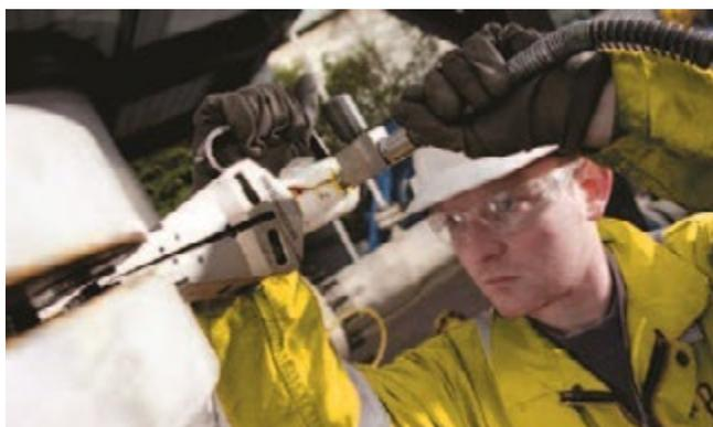
Hydratight предлагает широкий выбор вспомогательных изделий, специально разработанных для быстрого монтажа и демонтажа фланцевых соединений, включая съемники и разделители фланцев, устройства для срезания гаек и электроинструмент для ввинчивания болтов (ESDT).
