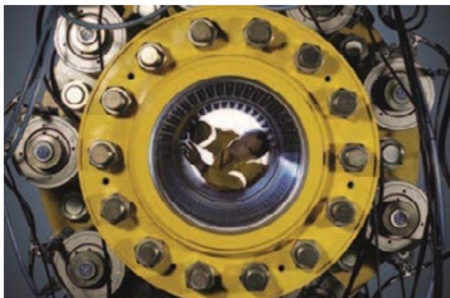
Ассортимент механических соединительных блоков Hydratight (ранее соединительные блоки Morgrip) был разработан для обеспечения надежности и общепризнанной прочности соединений трубопровода без применения каких-либо высокотемпературных работ. Соединительные блоки для палубных, морских и подводных конструкций созданы на основе уникальной системы шарового захвата и графито-металлического уплотнения труб.
