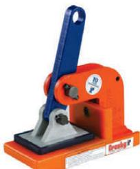
Захваты IPRNM10 для подъема в горизонтальном положении оснащены механизмом преднатяжения, позволяющим пользователю закрепить захваты на материале для подъема и переноса в горизонтальном положении не прогибающихся материалов. Для использования в случаях, когда не допускается повреждение поверхности материала. Эти захваты должны использоваться в количестве не меньше двух.
