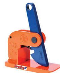
Захваты IPR10 для подъема в горизонтальном положении оснащены пружинным механизмом преднатяжения, позволяющим пользователю закрепить захваты на материале для подъема и переноса в горизонтальном положении не прогибающихся материалов. Эти захваты должны использоваться в количестве не меньше двух.
