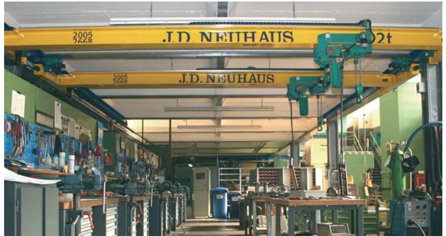
JDN-Hängekrane mit Flachlaufkatze in der Montage
