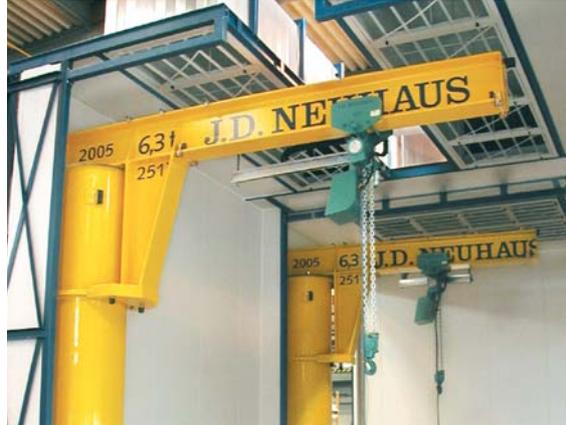
JDN-Säulenschwenkkrane in einer Lackierkabine, Tragfähigkeit 6,3 t
