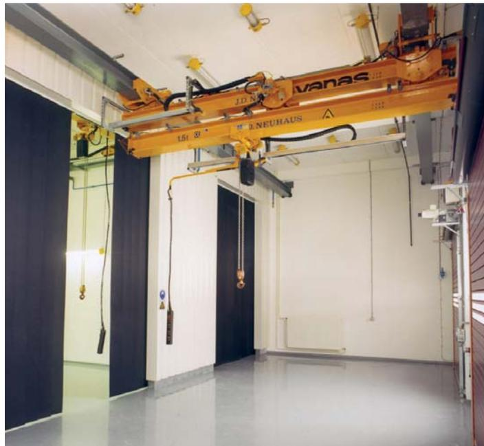
JDN-Einträger-Hängekran mit ausfahrbarem Träger mit Laufkatze
