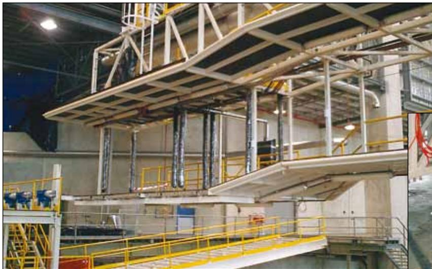
◀ Позиционеры Uni-Lift® оказались идеальным выбором для позиционирования и регулировки положения лесов сложной конструкции, возведенных для ремонта самолета. Точность перемещений и гибкость были важнейшим обстоятельством, необходимым для эффективного и безопасного выполнения этого задания.
