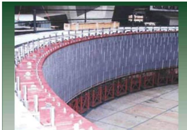
144 узла Винт-колпачок поддерживают внешнюю стенку большого генератора на плотине Grand Coulee.
