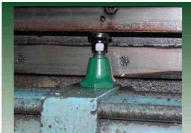
Модель S3A, в силу небольшого размера как самого домкрата, так и опоры, стала идеальным решением при подъеме основания этой дробильной машины.
