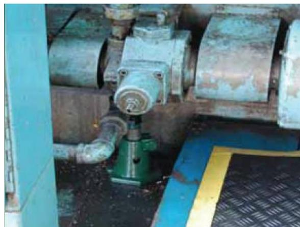
Зазубренное основание и шарнирный колпачок зацепа обеспечивают выжимным домкратам SIMPLEX возможность применения для нивелирования, ремонта и технического обслуживания фундаментов под оборудование и двигатели.
