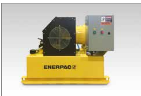
◀ Электрический насос с большим охладителем и органами управления для работы при высоких температурах.
