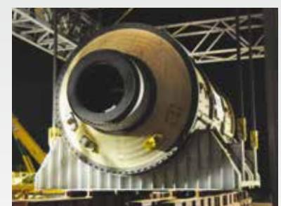
При строительстве крупнейшей в Австралии шахты по добыче магнетита и выполнении производственных операций использовалась система подъема грузов Enerpac с тросовыми домкратами. Система тросовых домкратов серии HSL обеспечила подъем и установку на основание соединенных между собой 800-тонных дробилок для железной руды и 1400-тонных самоизмельчающих дробилок на высоте 21 м над землей.
