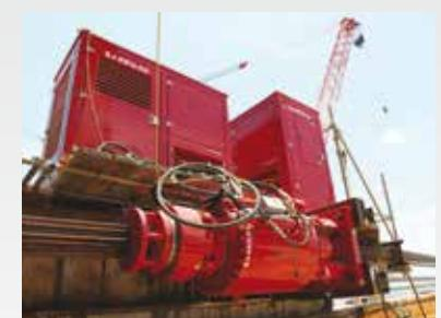
В ходе строительства платформы Tension Leg, предназначеннной для морской добычи нефти в Мексиканском заливе при глубине моря более 1525 м, при операциях по разгрузке модулей силового, бурового и перерабатывающего оборудования применялись тросовые домкраты Enerpac. Каждый из этих модулей весил около 6350 тонн; для его разгрузки требовалось тянувшее усилие 1360 тонн.
