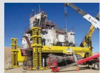
В горнодобывающей отрасли критически важное значение имеет минимизация простоев оборудования. Компания Enerpac предлагает мощное и безопасное решение для эффективного подъема и технического обслуживания ковшей горнодобывающего оборудования. Система синхронного подъема Enerpac автоматически синхронно поднимает и опускает цилиндры, избавляя тем самым от необходимости привлечения нескольких операторов. Система синхронного подъема позволяет повысить безопасность и производительность работ.
