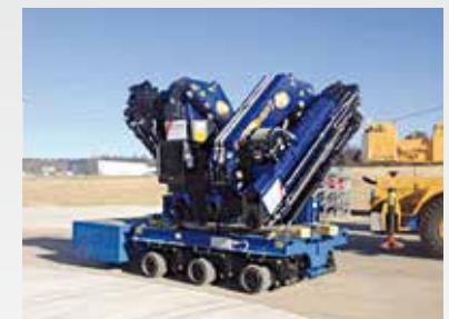
При установке радиационной защиты нижней части реактора необходимо было переместить стальную плиту диаметром 4,2 м и толщиной 0,9 м через узкий проход монтажного люка здания реактора. Чтобы не терять зря время, ожидая подготовки более широкого прохода для транспортировки плиты, с помощью порталного крана SPMT600 удалось переместить плиту через имеющийся проход и тем самым сэкономить критически важное для реализации проекта время.
