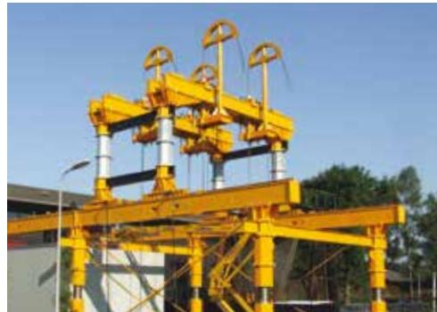
Гидравлический подъемник с тросовыми домкратами представляет собой стальную конструкцию, облегчающую подъем и перемещение вперед, назад и в стороны тяжелых грузов. Гидравлический подъемник с тросовыми домкратами Enerpac позволяет выполнять работы в условиях ограниченного рабочего пространства.
