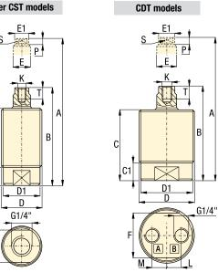
Force: 1,7 - 39,2 kN Stroke: 7,3 - 51,6 mm Pressure: 40 - 350 bar **E** Cilindros roscados
