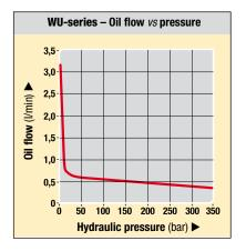
Flow: 0,33 l/min Pressure: 350 bar max Motor: 0,37 kW Reservoir: 1,9 - 3,8 litres
