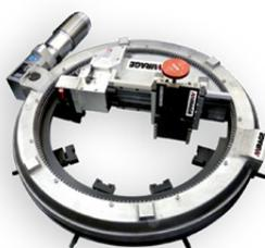
Привод с поперечным роликом и предварительной нагрузкой, для качественной обработки с повторяющимся результатом
