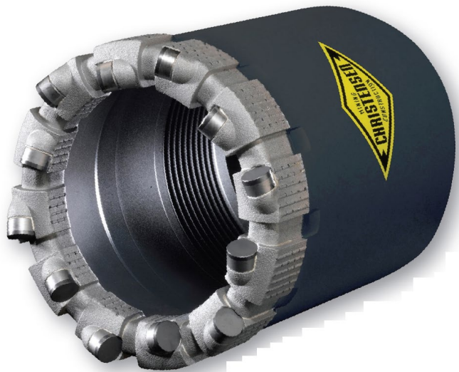
Кольцевая буровая коронка CSK 146 PDC Core Bit, армированная поликристаллическими синтетическими алмазами
