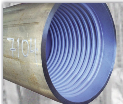
Неразрушающий контроль (напр., проверка герметичности методом проникающего красителя, видимого при ультрафиолетовом излучении)
