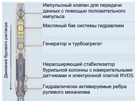
Рисунок 1. Изображение MICON- RVDS в разрезе
