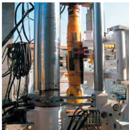
Рисунок 5. Установка RVDS (РБУВБ) в процессе измерения на роторе RBM Robbins 85R
