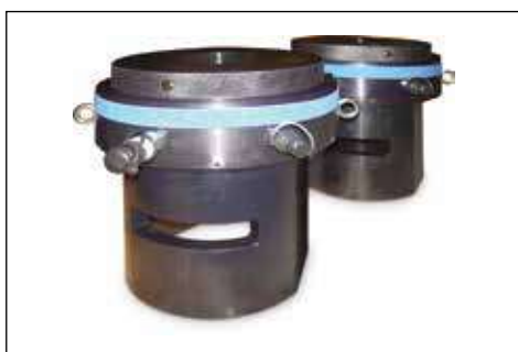
◀ Специализированные гидравлические натяжители для работы со шпильками на 5 дюймов, развиваемое усилие – 4200 кН.
