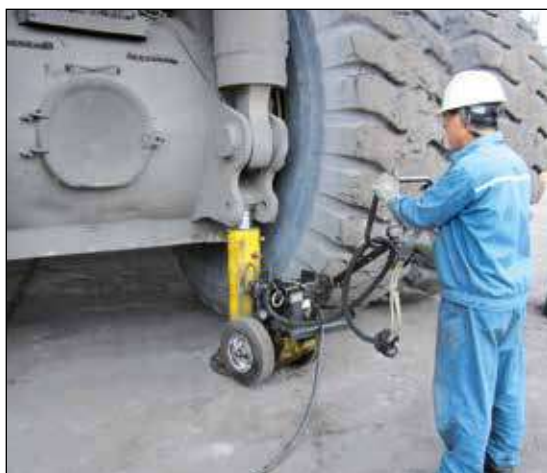
◀ Энерпас Pow'r-Riser® используется в горнодобывающей промышленности для подъема тяжелого оборудования.
