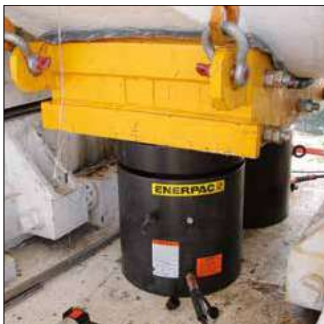
▲ Подъем тяжелых грузов и выравнивание оснований. Стопорная гайка обеспечивает механическое удержание груза в течение длительного времени.
