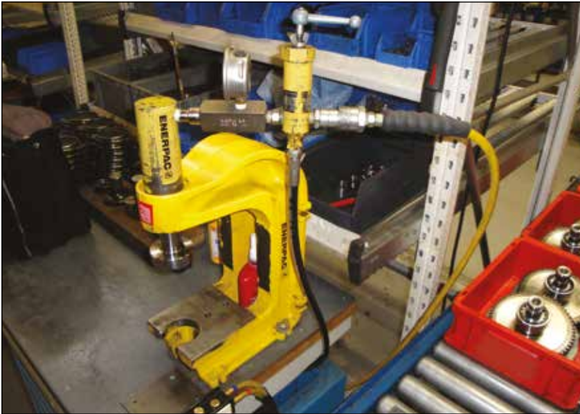
▲ Цилиндр RC-308 в оправочном прессе А-330 с приводом от пневматического насоса PATG-Turbo для контролируемой выпрессовки и запрессовки подшипников ткацких станков. Предохранительный клапан V-152 ограничивает усилие прессы.
