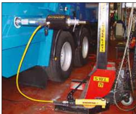
◀ RACH-306 с ручным насосом P-392 используется для извлечения закорродированных осей из мусороборочной машины.
