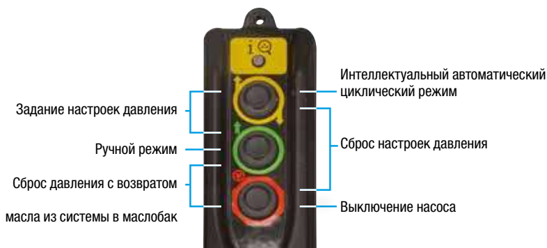
Пульт управления с 6-метровым проводом
